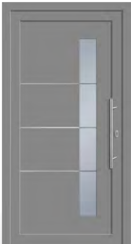
P-FAVORIT 22 Ansicht B / DIN rechts aufgesetzte Streifenapplikation in Edelstahloptik außen F ■ Dekor Graualuminium ■ Sandstrahlmotiv Y 1850 auf Klarglas | MG 3 ■ Griff ZAE 6s, 600 mm | PG 6
