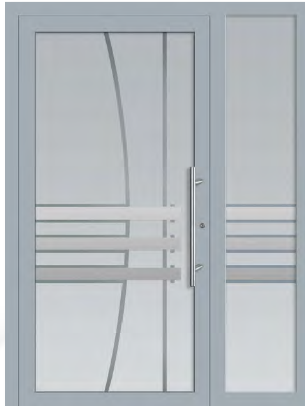
V-476 Ansicht B / DIN rechts Ganzglasfüllung 3-fach Glas, Ug 1,7 bei 28 mm und Ug 1,1 bei 36 mm helle Flächen mattiert, dunkle Streifen Klarglas, Streifenapplikationen in Edelstahloptik ■ Griff ZAE 6s, 600 mm | PG 6 ■ Seitenteil Sandstrahlmotiv mit Applikationen in Edelstahloptik V-ST 476
