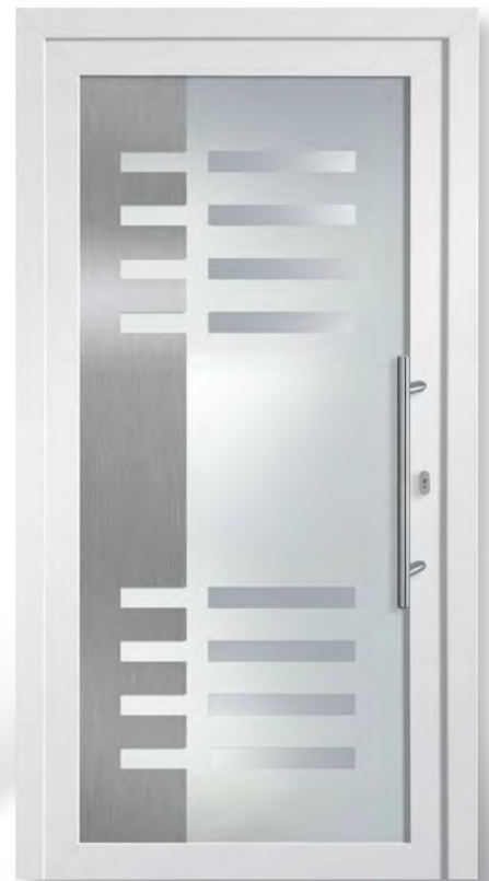
V-472 Ansicht A / DIN rechts Ganzglasfüllung 3-fach Glas Ug 1,7 bei 28 mm und Ug 1,1 bei 36 mm helle Flächen mattiert, dunkle Streifen Klarglas, kammartige Applikation in Edelstahloptik ■ Griff ZAE 6s, 600 mm | PG 6
