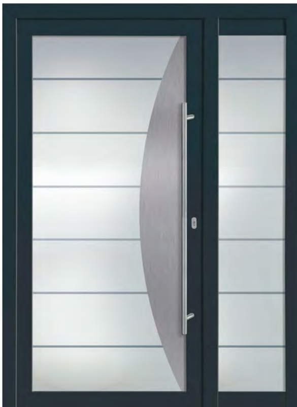
V-492 Ansicht A / DIN rechts Ganzglasfüllung 3-fach Glas Ug 1,7 bei 28 mm und Ug 1,1 bei 36 mm dunkle Streifen Klarglas, helle Flächen mattiert, bogenförmige Applikation in Edelstahloptik ■ Griff ZAE 6s, 1200 mm | PG 6 ■ Seitenteil Sandstrahlmotiv V-ST 492
